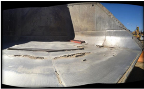
Fracturas comunes y recubrimientos dañados en tolvas recubiertas con acero
