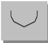
**Fondo en “V”:** Es una tolva que tiene una pendiente del lado izquierdo y una pendiente del lado derecho formando una “V” mirando hacia abajo de la cola de la tolva.
