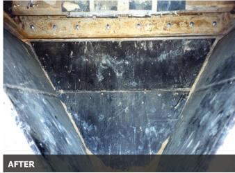
(Antes) Un ejemplo de un chute de respaldo, debido a la acumulación de material. (**Después**) Un ejemplo de un chute sin material adherido, con los recubrimientos inflables de Valley Rubber.
