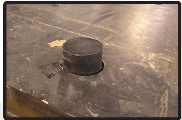
Se proveen tapones de goma para cada orificio a presión para proteger los elementos de sujeción. Puede usar agua en los tapones para hacer que se deslicen con facilidad.
