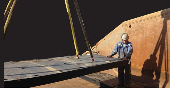
Nuestros recubrimientos de caucho para camiones de gran tonelaje absorben energía, protegen la superficie del material altamente abrasivo y disminuyen dramáticamente el costo de mantenimiento. El sistema de recubrimientos de Valley Rubber es superior a los revestimientos de acero convencionales si es que estos han sido diseñados de forma correcta para la aplicación.
