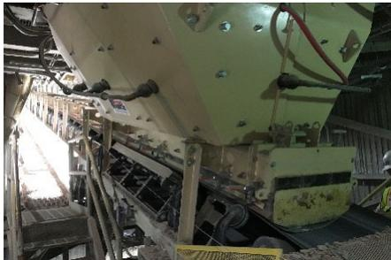
**Solución:** El Sello de Cola utiliza un sistema que se compone de 3 láminas de caucho ajustables usando tornillos de mango tipo T de acero inoxidable. Esto permite tres puntos de contacto que sellan la banda. Luego para fines de inspección y mantenimiento el sistema puede abrirse gracias a bisagras superiores que permite el acceso.
