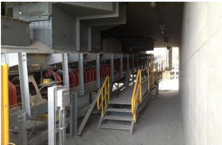
**Solución:** La solución de Valley Rubber incluyó la incorporación de guías de carga con sellos de polvo de doble labio, acortar la distancia entre las barras de impacto. Las barras ajustables estabilizadoras de banda se instalaron entre los rodillos. Se instaló además un sello de cola haciendo que el mantenimiento del equipo de 3 personas se haga una vez cada dos semanas.
