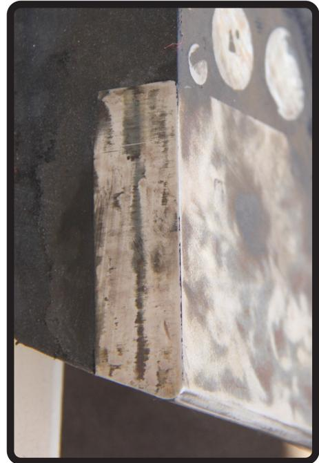
**El Revestimiento HardLine Plus en las Guarderas o Placas (Canoe Liners) utilizan una combinación de cerámica para maximizar su performance. Cerámica Biselada a sido creada para que trabaje junto a la banda mientras los Cilindros Duros se usan arriba del ladrillo cerámico.**
