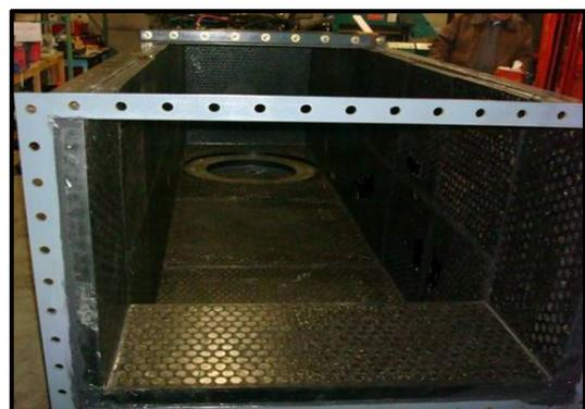
Los recubrimientos de caucho cerámico se fijan con imanes internos. No se necesita hacer huecos ni colocar pernos.
