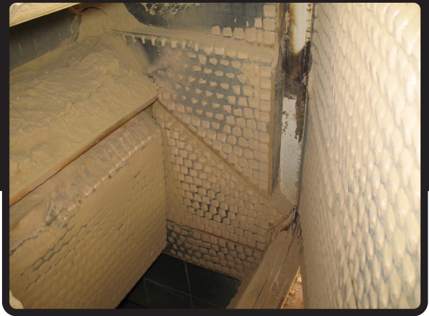
Revestimientos de Cubos Cerámicos aplicada en la Puerta Triple del Alimentador puede soportar condiciones extremas de impacto y abrasión por años.
