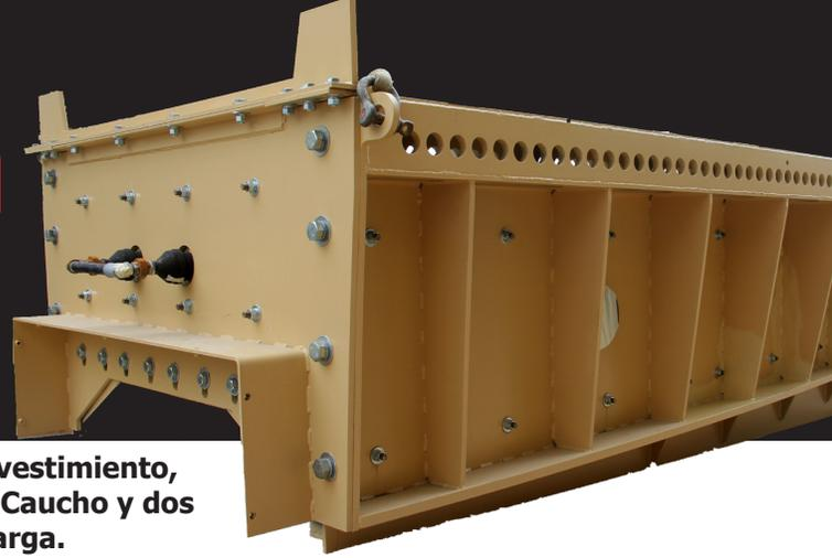
En la imagen: Alimentador K2 - Sistema Alimentador con Revestimiento, incluye seis Revestimientos Inflables, dos Revestimientos de Caucho y dos Revestimientos de Caucho-Cerámica en la zona de carga.
